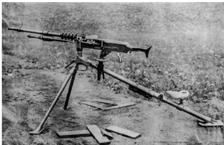
La ametralladora Hotchkiss 1914 es fácilmente reconocible por los disipadores de calor, en forma de cinco grandes discos rodeando el cañón del arma.
